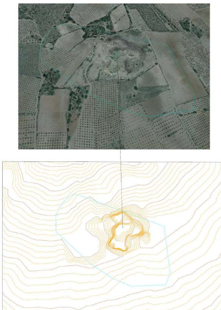
Figura 30. Simulación 3D y curvado de situación preoperativa de la Concesión “Caudete” n1 3127 donde se puede observar lo que será el hueco de explotación (contorno azul) la zona 3 ya parcialmente explotada.
