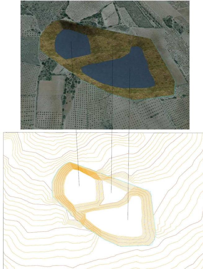
Figura 10. Simulación 3D y curvado de situación de la Concesión “Caudete” nº 3127 tras la Fase 3 de restauración, donde toda la superficie de la ampliación ya estará restaurada con las dos balsas de agua creadas y zonas para reforestar alrededor de dichas balsas (trama en verde).
