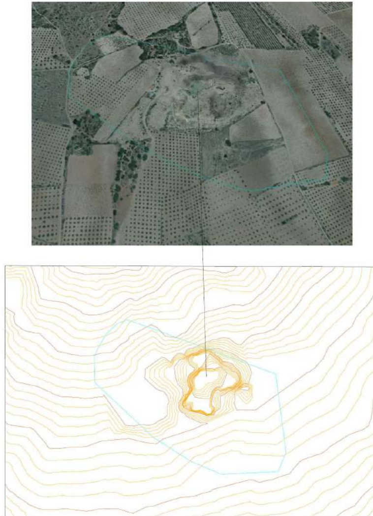
Figura 4. Simulación 3D y curvado de situación preoperativa de la Concesión “Caudete”n1 3127 donde se puede observar lo que será el hueco de explotación (contorno azul) la zona 3 ya parcialmente explotada.
