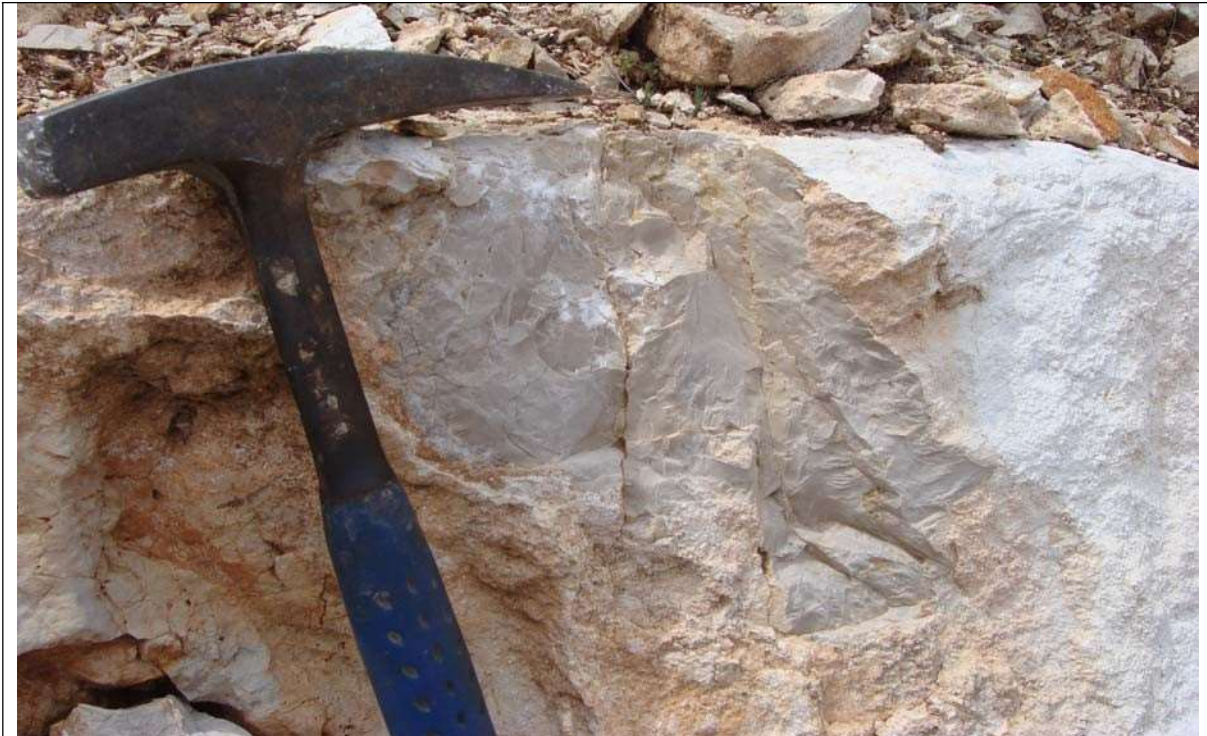
Fotografía n° 6.- Detalle de la caliza blanquecina en superficie y gris en corte fresco, que se observa en la zona que se pretende explotar.
