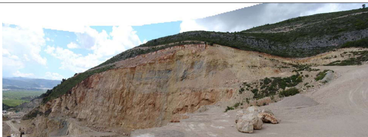
Fotografía n° 3.- Vista del frente que se pretende explotar donde se aprecia la formación de calizas con tramos margosos y sobre ella, aun sin explotatar las calizas del Santoniense bien estratificadas.
