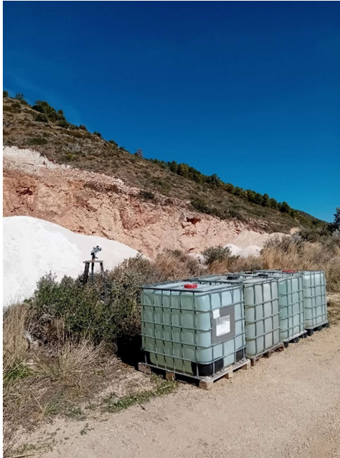
Ilustración 4: Sistema Riego de acopios
