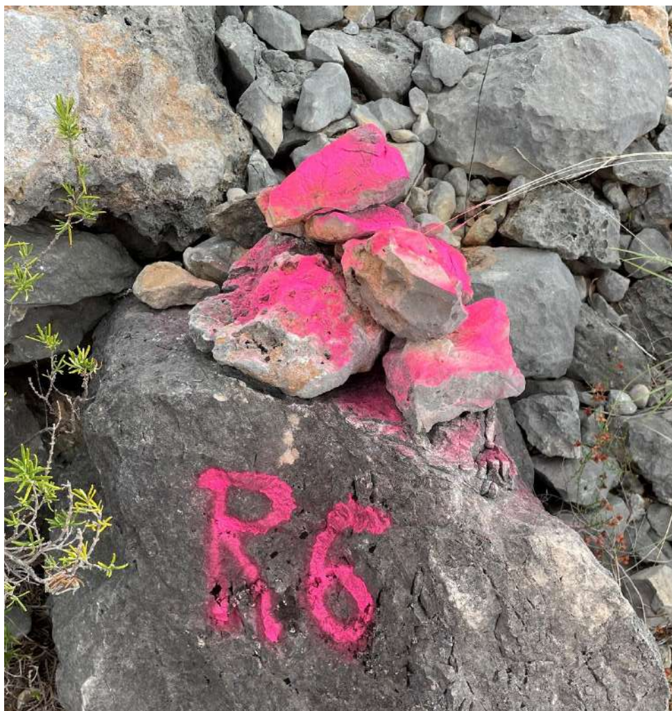
Ilustración 4: Ejemplo del vértice R-6, ubicado al nivel de una roca gorda, sin estaca de madera porque estaba imposible a plantar.
