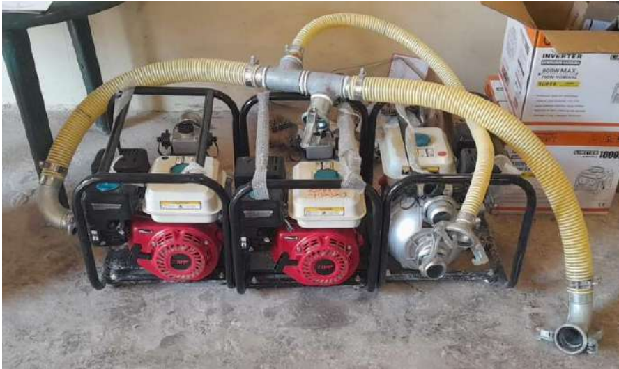
Ilustración 5: Motobombas que se usarán para alimentar los cañones de agua
