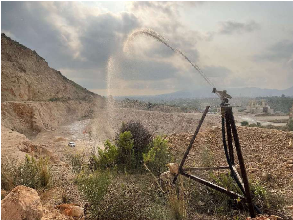
Ilustración 3: Cañón funcionando y haciendo la cortina de agua
