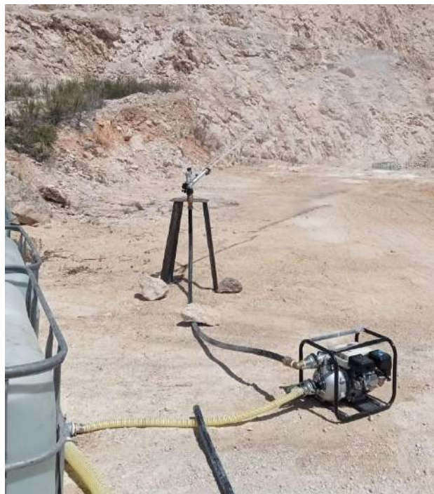
Ilustración 4: Cañón de agua haciendo la cortina, con sus propios G.R.Gs y motobomba
