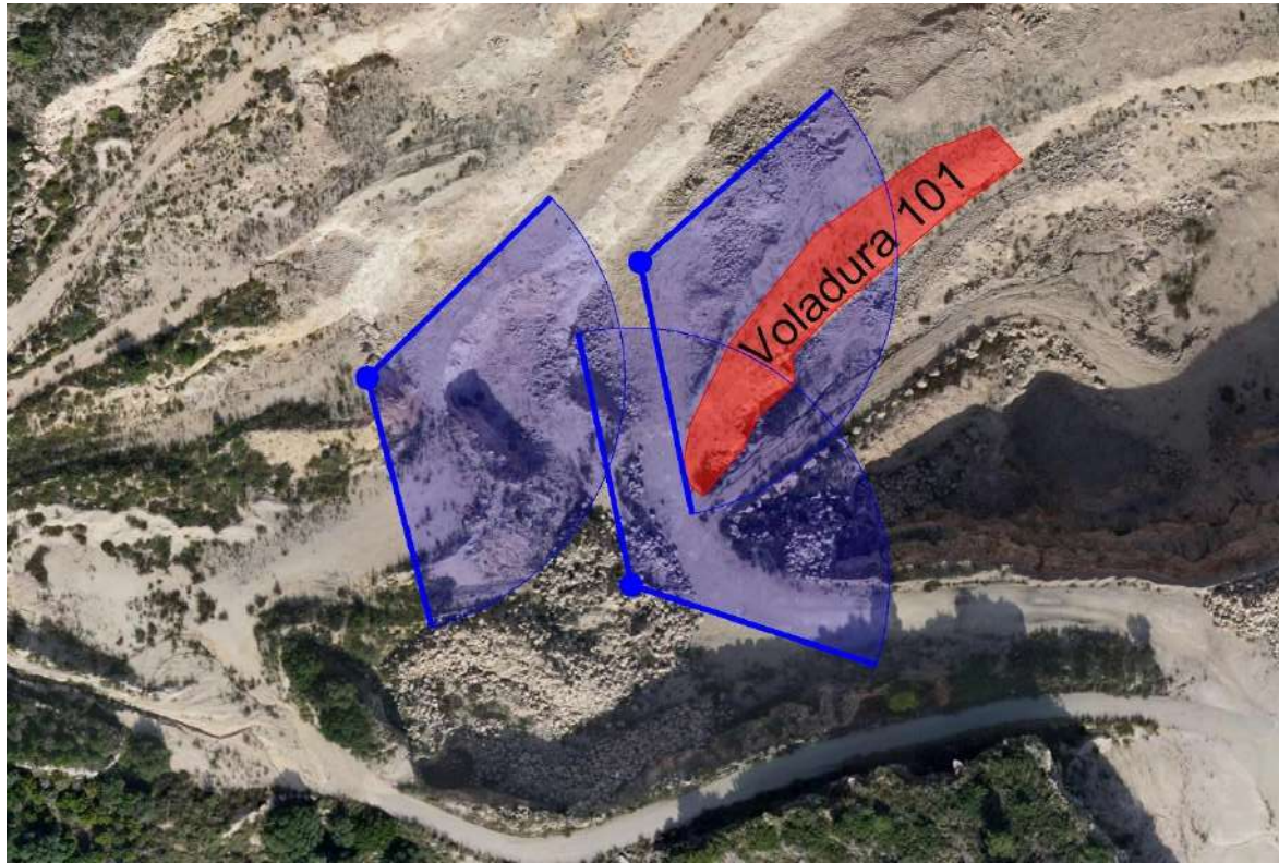
Ilustración 3: Ubicaciones de los cañones de agua y superficie de riego
