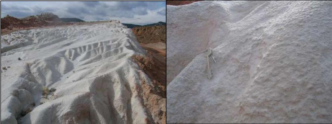
**Fotografías nº 4 y 5.-** (Izq) Banco de caolín con algunos cantos centimétricos a techo y (dcha) detalle del aspecto que presenta el material.
