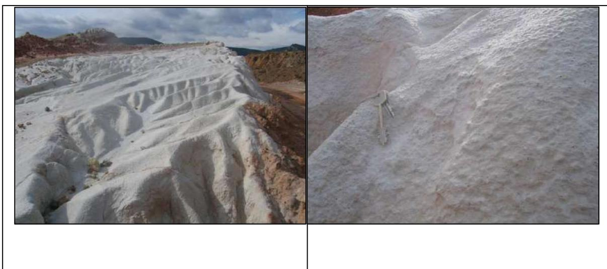
**Fotografías nº 4 y 5.-** (Izq) Banco de caolín con algunos cantos centimétricos a techo y (dcha) detalle del aspecto que presenta el material
