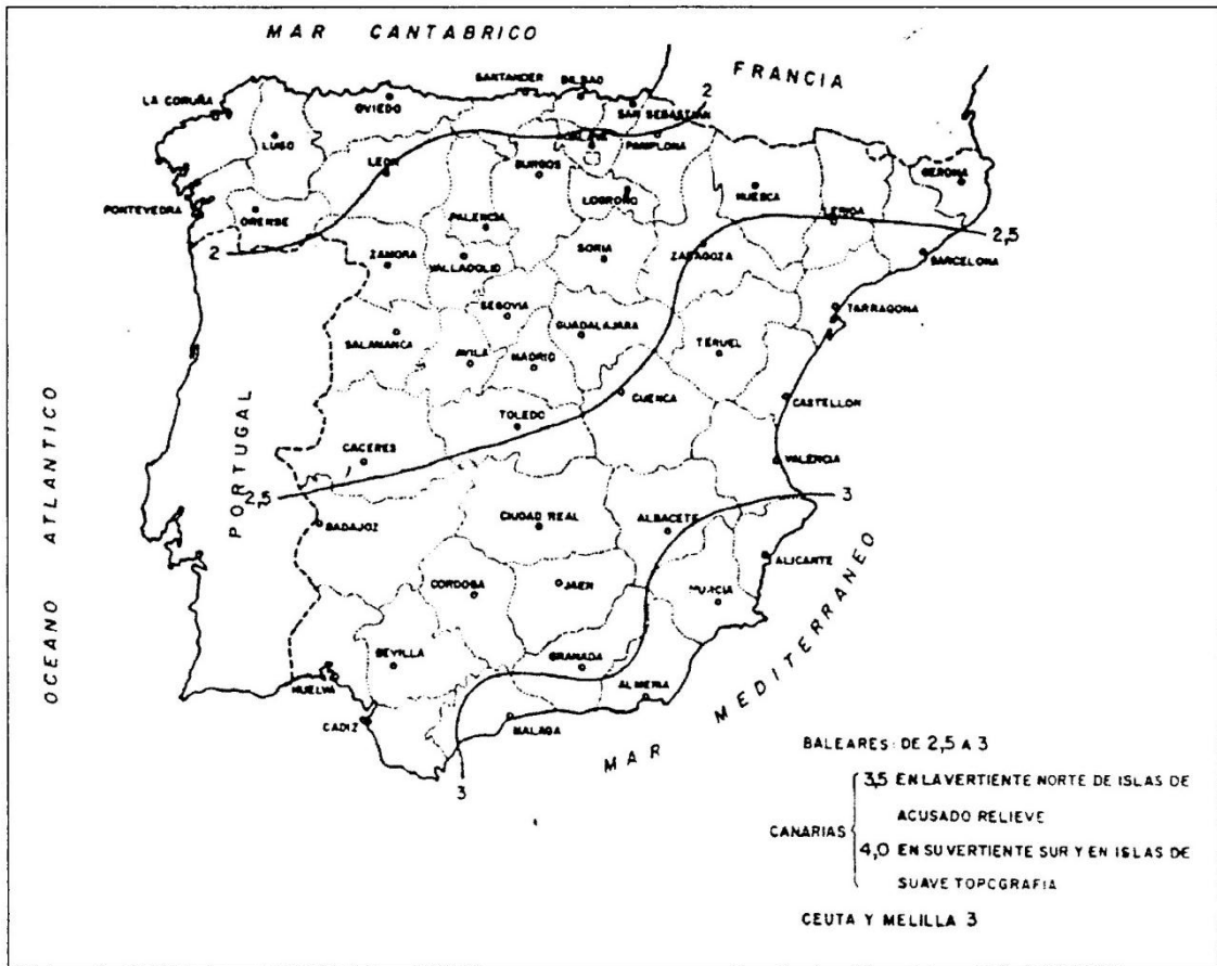
Figura 4: Mapa del coeficiente corrector del umbral de escorrentía (Instrucción 5.2-IC)
