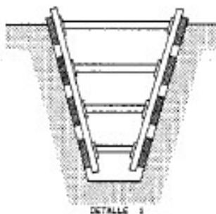
*Detalle de entibación horizontal para zanja con sobrecarga y con profundidad notable.*
