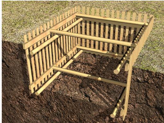
Ejemplo de entibación semicuajada para una protección del 50%, mediante tableros, cabeceros y codales de madera.
