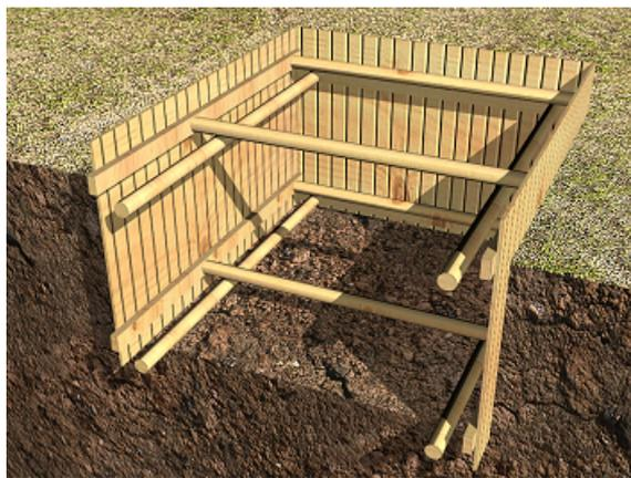
Ejemplo de entibación cuajada para una protección del 100%, mediante tableros, cabeceros y codales de madera.
