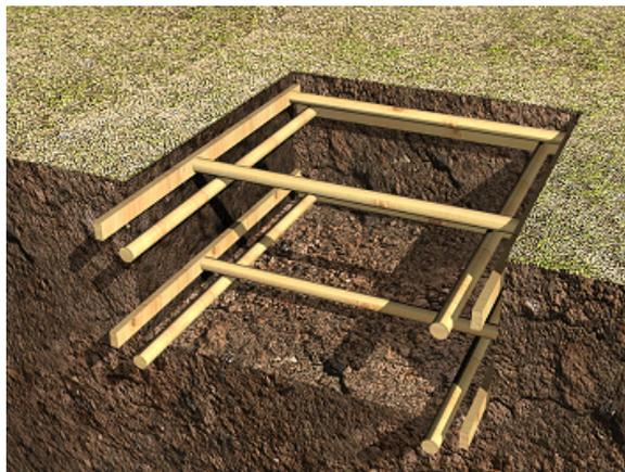
Ejemplo de entibación ligera para una protección del 20%, mediante tableros, cabeceros y codales de madera.
