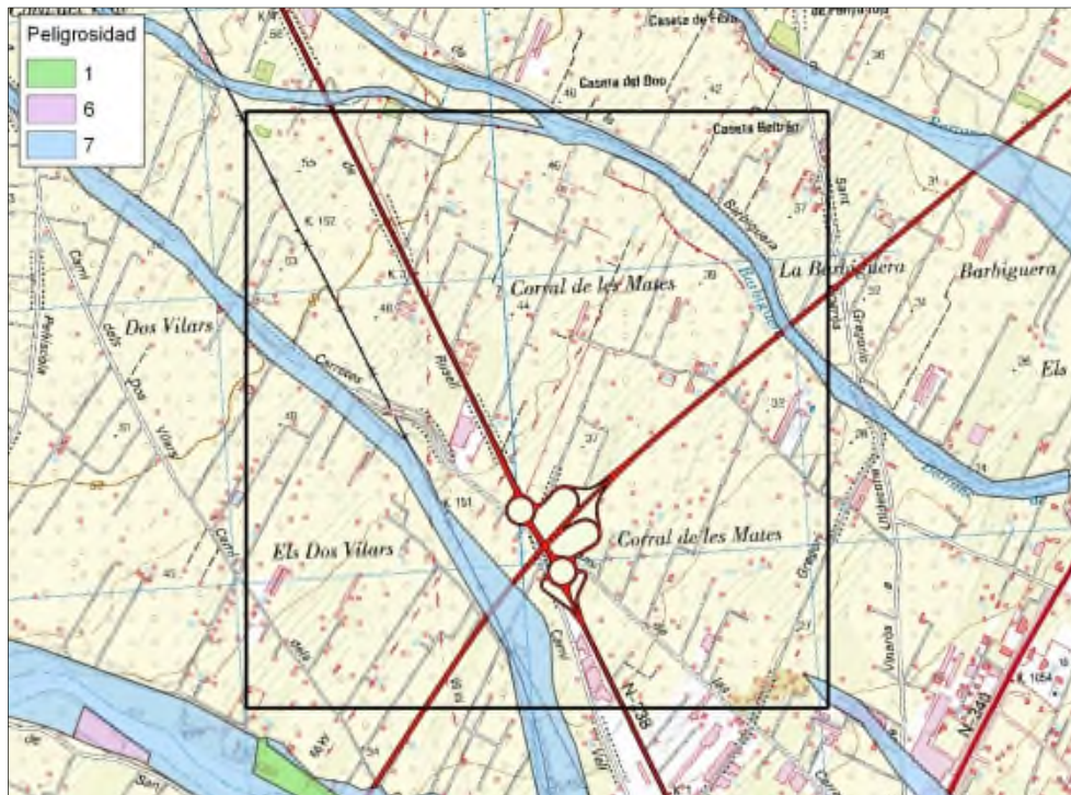
Figura 7-5. Zonas con peligrosidad por inundación. Fuente: PATRICOVA 2015
