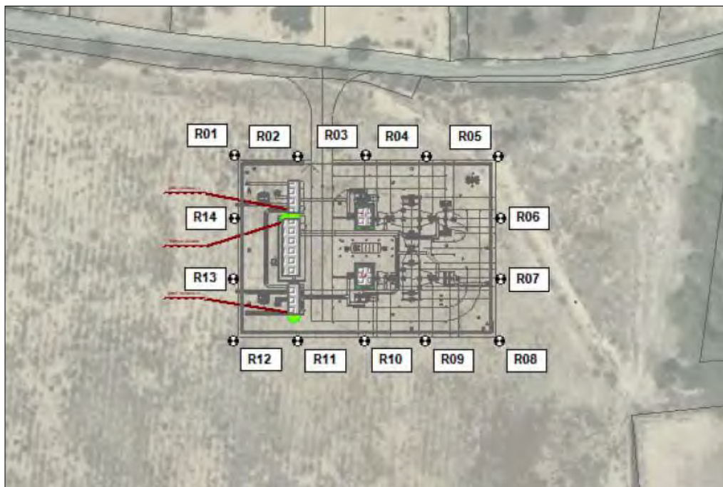
Figura 20. Receptores sonoros en el entorno de la subestación
