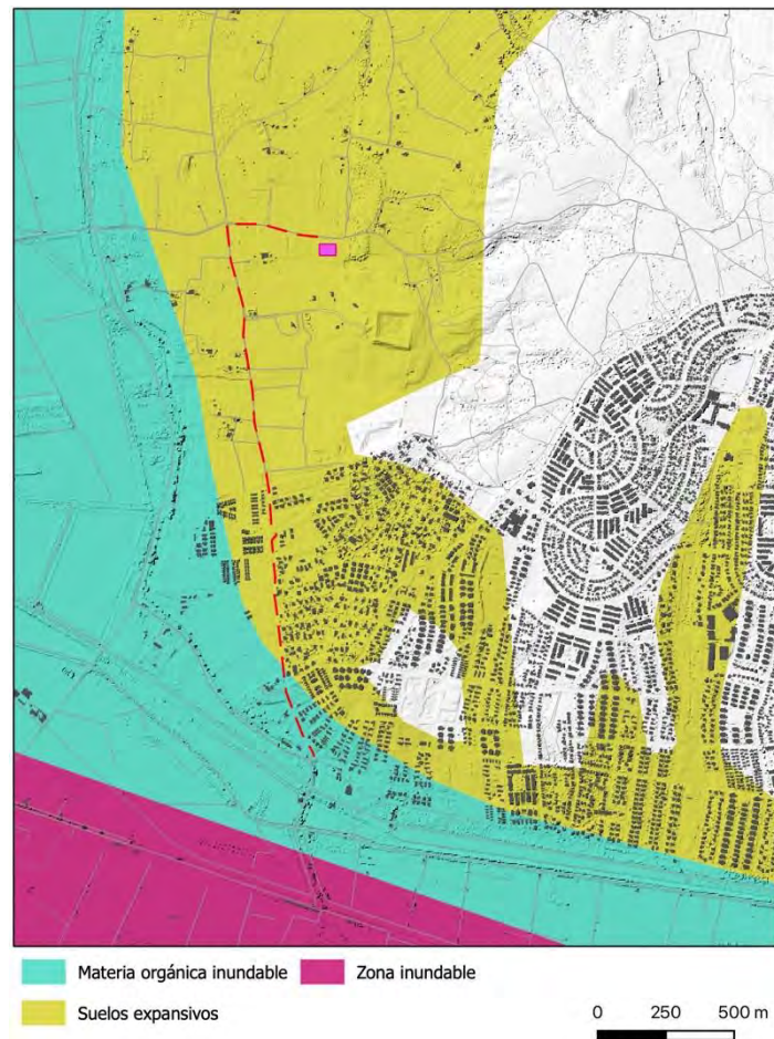
Figura 24. Riesgos geotécnicos. Fte.: IVE
