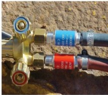
DETALLE A DOBLE VÁLVULA ANTIRRETORNO
